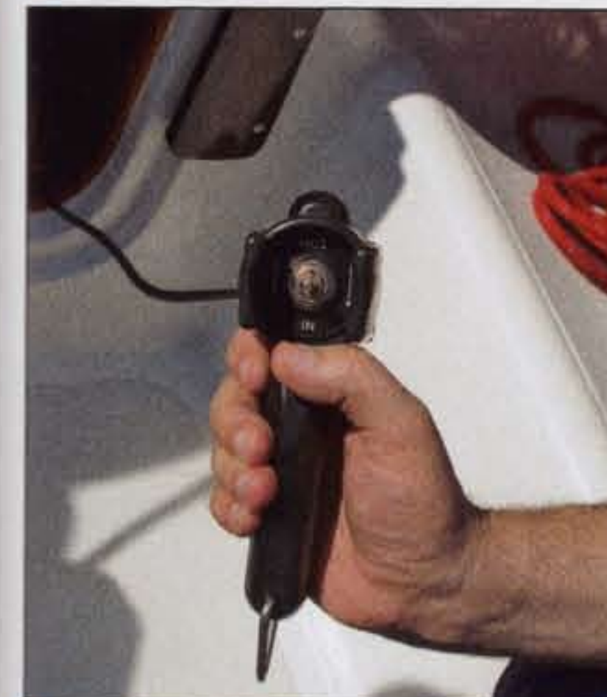
■ Pilot sterujący silnikiem elektrycznym do podnoszenia i opuszczania miecza
